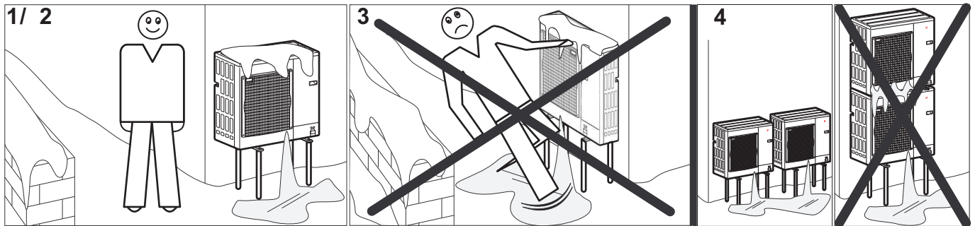
Fig.20 Instalación de uno o varios módulos exteriores
