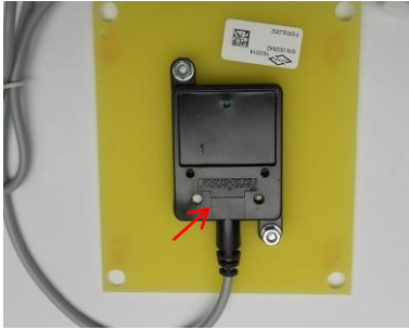
Figura 23 – Regulación de sensibilidad del sensor de nivel
