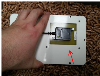
Figura 28 – Regulación de la sensibilidad del sensor
