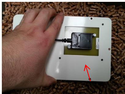
Figura 28 – Regulación de la sensibilidad del sensor
