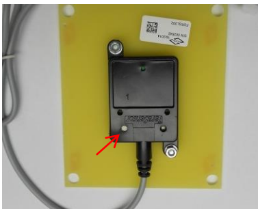
Figura 23 – Regulação da sensibilidade do sensor de nível
