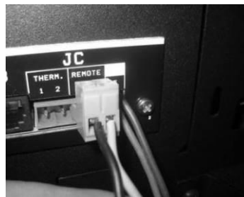
Figura 18 – Ligação do comando remoto sem fios
