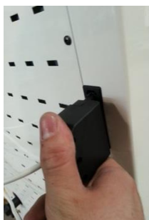
Figura 48 – Conexión del sensor a la placa electrónica
